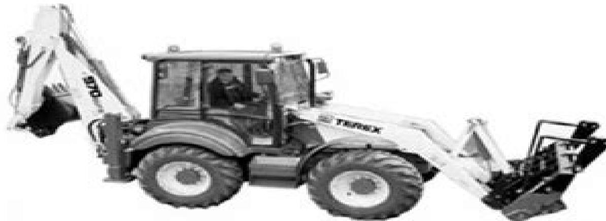
Показана модель: 970 Elite (версия со сдвинутой (смещенной) обратной лопатой)
