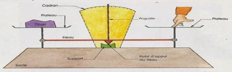
Une balance est un levier. Le point d'appui est au milieu du fléau.
