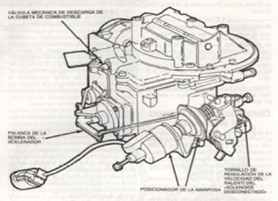
Carburador para motor 2150, con solenoide
