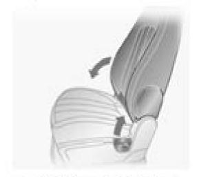
Tire de la palanca, ajuste la inclinación y suelte la palanca. Deje que el respaldo enclave audiblemente. No se apoye en el respaldo mientras lo ajusta.
