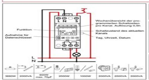
Wirkungsweise Typ 1.B. S. T. IEC/EN 60730-1, IEC/EN 60730-2-7 Betrieb in üblicher Umgebung. Montage: Verteilereinbau, Verschmutzungsgrad: 2 Schaltausgang potentialfrei Bemessungsstossspannung: 4 kV
