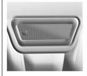
La luz se encenderá automáticamente al abrir cualquier puerta y se apagará poco después de cerrar las puertas. Si quiere apagar la luz con la puerta abierta, pulse el botón que hay en la lámpara. Puede encender o apagar manualmente la luz pulsando dicho botón.
