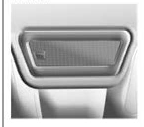
La luz se encenderá automáticamente al abrir cualquier puerta y se apagará poco después de cerrar las puertas. Si quiere apagar la luz con la puerta abierta, pulse el botón que hay en la lámpara. Puede encender o apagar manualmente la luz pulsando dicho botón.
