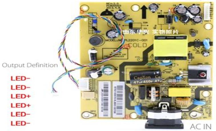
12V 12V GND GND N/F ADJ 5V
