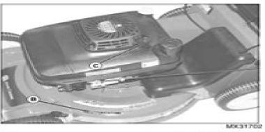
Colocar el pio izquierdo en la efigueta (B) que dice "STEP HERE" ("PISE AQUÍ") en la parte superior izquierda de la plataforma.
