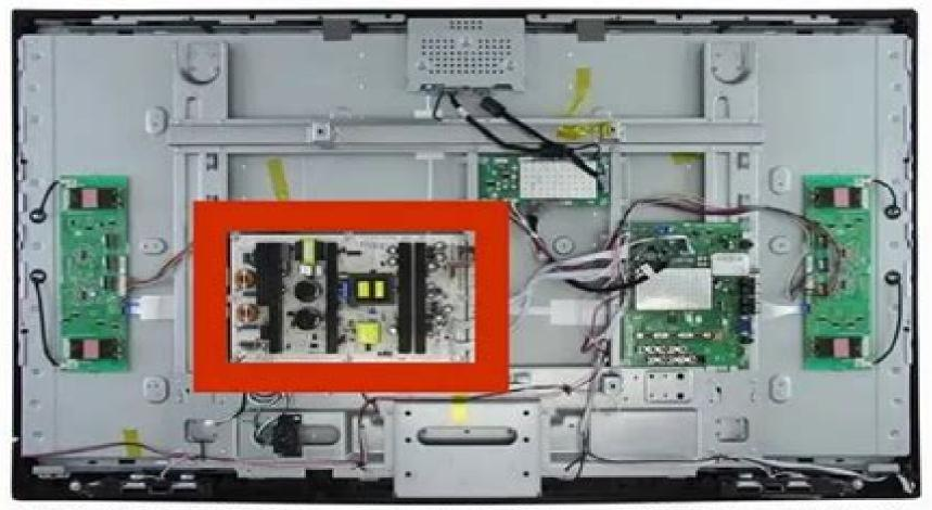
POWER BOARD - CAPACITOR - POWER SUPPLY
