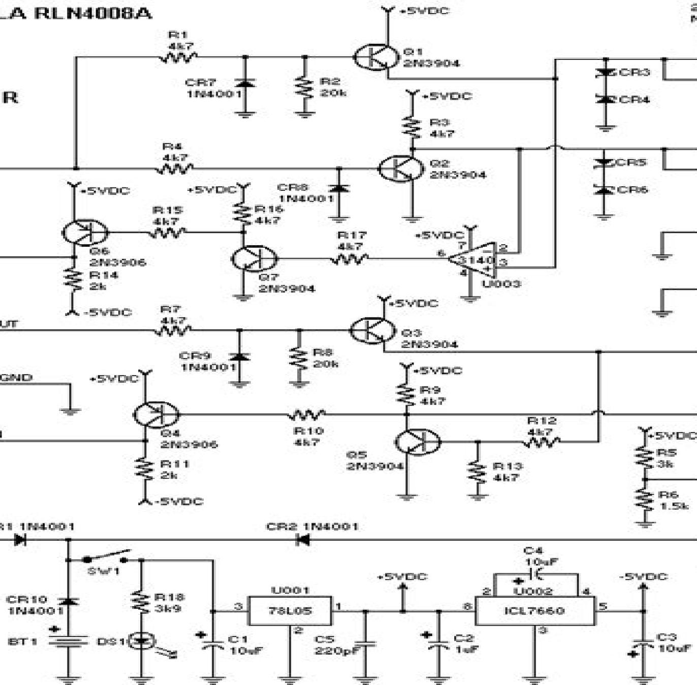
**RADIO INTERFACE BOARD SCHEMATIC**
