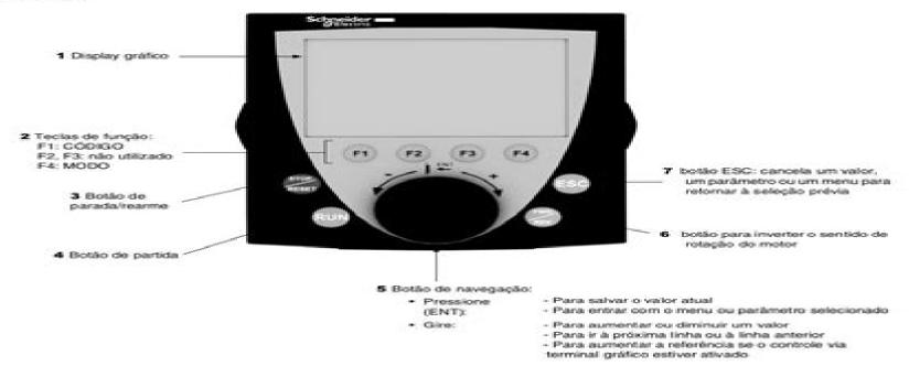
Nota: Teclas 3, 4, 5 e 6 podem ser utilizadas para controlar o inversor diretamente, se o controle via terminal estiver ativado.
