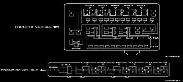
NOTE: THE TRIANGLE MARK ON THE RELAY HOUSING SHOULD FACE THAT ON THE RELAY BOX.
