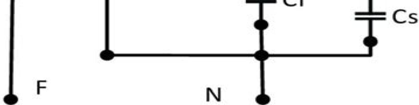
**Gambar 2** Bentuk hubungan kapasitor start ‘Cs’ dan kapasitor jalan ‘Cr’ pada kumparan motor induksi 1-fasa jenis ‘*capacitor start-capacitor run induction motor*’.
