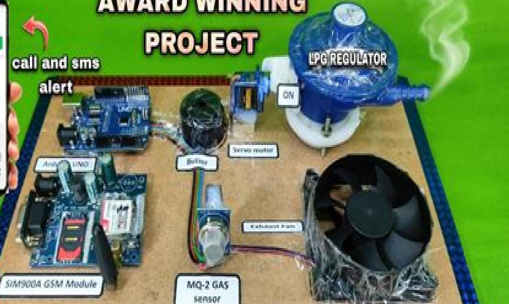
ADVANCED LPG GAS LEAKAGE DETECTION SYSTEM WITH AUTO CUT-OFF GAS
