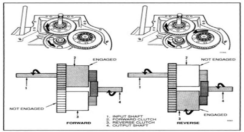
FIGURE 8. CLUTCH OPERATION
