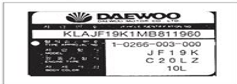
Fig. 2 Plăcuța cu numărul de identificare a vehiculului (V.I.N)
