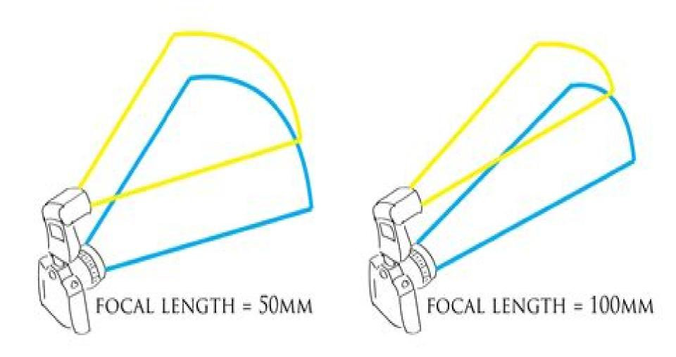
THE FLASH COVERAGE FITS THE FOCAL LENGTH ANGLE OF VIEW
