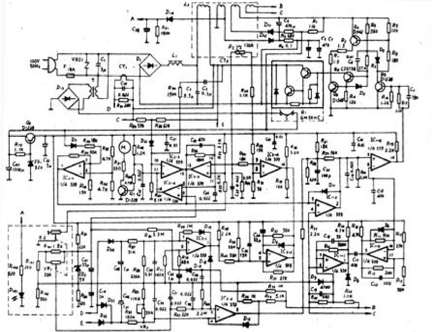
电源:交流 220V.50Hz 设有过压、过热保护,据具检测电路。
