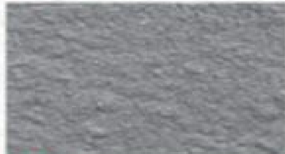
CSP 5 (medium-heavy shotblast)
