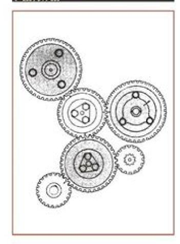
Con el pistón Nº 1 en PMS. Fase de compresión. Coincidencia entre las mercas de los engranajes intermediarios con las comespondientes de los engranajes del árbol de levas, bomba de inyección y cigüefial. Una marca existente en el cubo del engranaje de la bomba inyectora coincidirá con otra situada en el adaptador triangular de este mismo engranaje.
