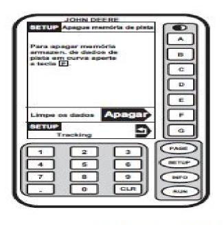
alfabético ao lado de APAGAR DADOS ARMAZENADOS DE PISTA CURVA, o sistema pede ao usuário que destigue e ligue a energia para apagar a memória.
