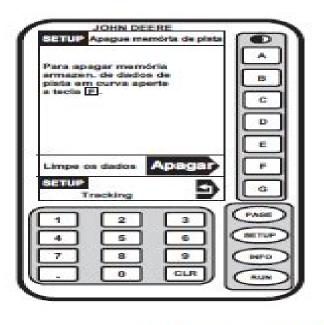
alfabético ao lado de APAGAR DADOS ARMAZENADOS DE PISTA CURVA, o sistema pede ao usuário que destigue e ligue a energia para apagar a memoria.
