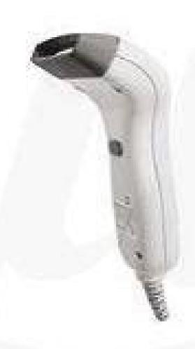
Leitor CCD Manual Elgin BS313/S Leitor CCD Serial sem fonte Bege
