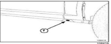
Pentru a pune vehiculul pe dispozitivele "lumânare", ridicați lateral ansamblul vehiculului și poziționați obligatoriu dispozitivele "lumânare" sub amplasamentul prevăzut pentru a poziționa cricul din echipamentul de bord (1).
