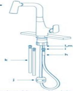
Rosque la punta de la manguera (h) en el tubo más largo (i). Asegure la pesa (j) por encima de la curva inferior de la manguera (h). Finalmente rosque las dos mangueras (k) en los tubos marcados con azul y rojo (l,m), y el otro extremo de las mangueras (k) conéctelo a las acometidas de agua fria y caliente.
