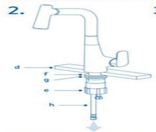
Desde abajo del mesón (d), rosque la tuerca (e) en el vástago (a), esta debe quedar apretada. Axegúrese de que la arandela de caucho (f) y la de metal (g) estén en el orden que muestra el diagrama. Hale la manguera (h) por completo.
