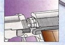
Système de chargement rapide Barillet à 8 coups permettant un chargement facile et rapide de l'arme.
