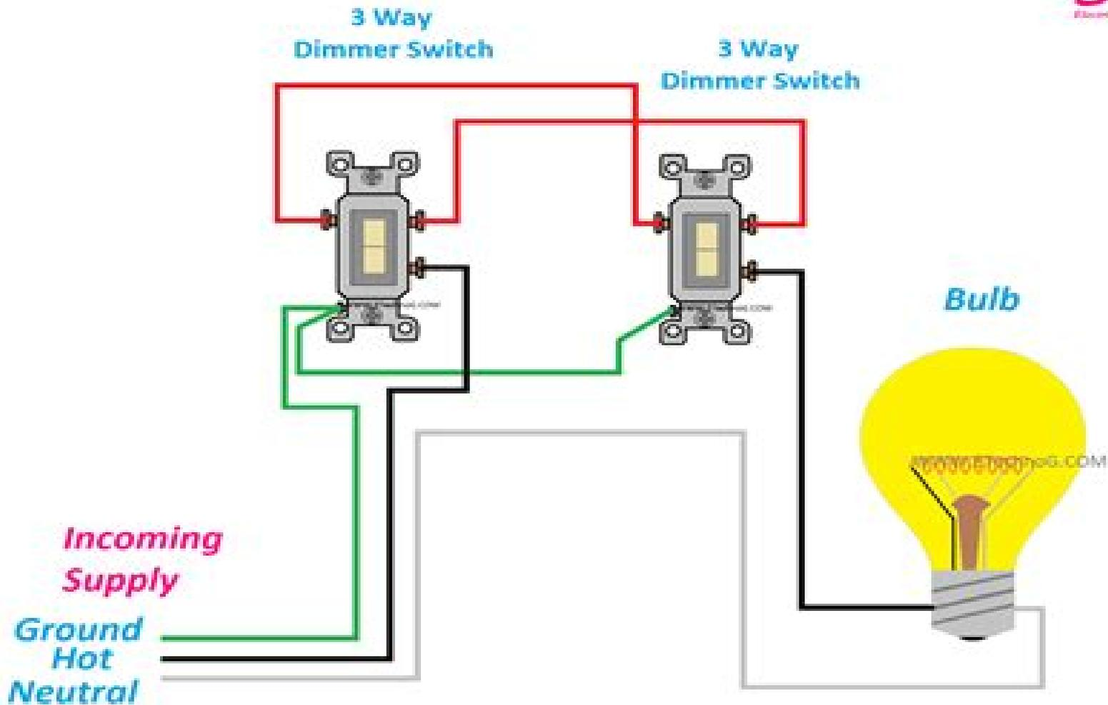
**3 Way Dimmer Switch Wiring Diagram**
