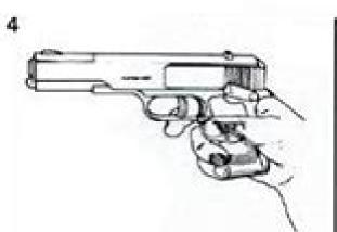
Den Abrug durch Hereindrücken der Abzugsicherung von der Iinken Seite der Pistole her sichern.
