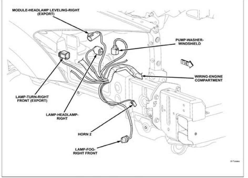
Fig. 2 ENGINE COMPARTMENT - FRONT RIGHT (LEFT SIMILAR)
