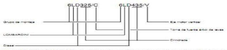
Una vez identificada la sigle comercial del motor, se pasa a la identificación del motor por medio del número de fabricación que aparece en la placa de características fijada en la caja ventilador y en la bancada.
