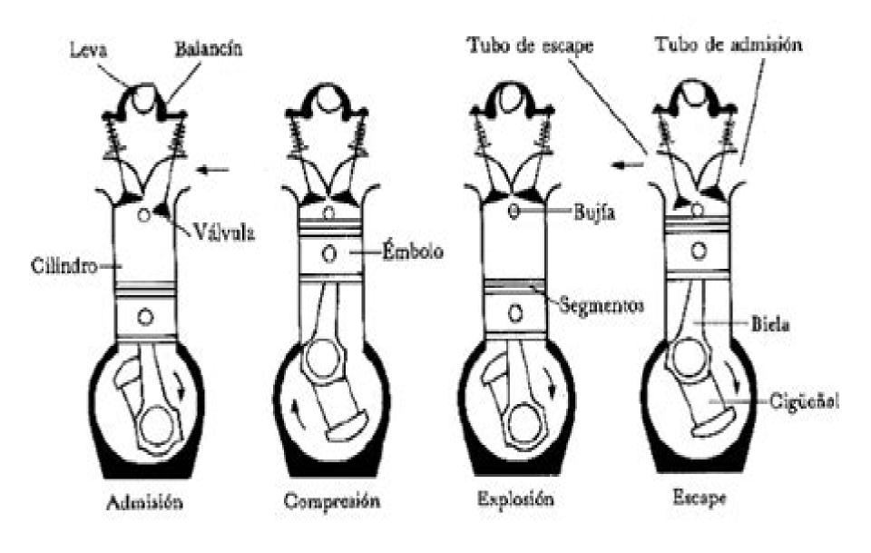
(Motor de 4 tiempos: Aquí vemos la estructura básica de un motor de cuatro tiempos con el nombre de todas las piezas básicas del motor)
