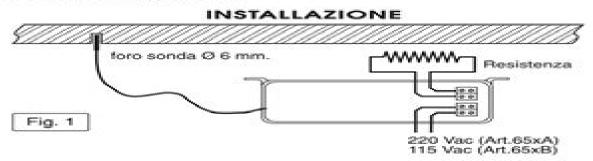
I collegamenti devono essere effettuati da personale qualificato seguendo lo schema in Fig.1. La resistenza di riscaldamento deve avere una potenza massima di 2200 Watt con alimentazione 220 Vac (Art.65xA) e 1150 Watt con alimentazione 115 Vac (Art.65xB). Apparecchiatura in classe II.
