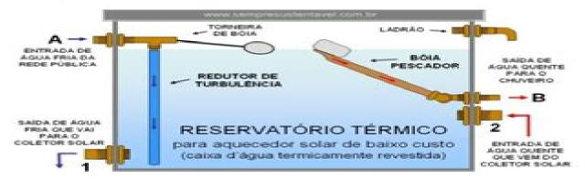
O reservatório é alimentado pela água da rede pública A (água fria) por uma torneira de bóia. Essa água é direcionada para o fundo do reservatório por um tubo (redutor de turbulência) encaixado na tomeira de bóia. Esse tubo, além de direcionar a água fria direto para o fundo do reservatório, tem a função de evitar turbulências, misturando momentaneamente as camadas de água quente e fria.
