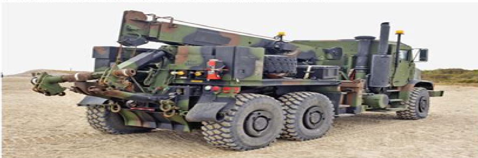
Der Einsatz der Hauptwinde der MX-M, MX-M4.1 und AMX-M Bergefahrzeuge erfolgt über das Fahrzeugheck. Die Hauptwinde von der Manufacturer besteht aus zwei Trommelwinden, die je eine Zugkraft von 15,876 kg haben. Die Ausstattungs der 16 mm dicken Winderwinde beträgt 97,5 m. The main winch of MX-M, MX-M4.1 and AMX-M Winchcars operates over the rear of the vehicle. Made by the Manufacturer, the winch system incorporates two drum winches, each with a maximum pulling capacity of 15,876kg. The winch cables are each 97,5m long and 16mm thick. (Carl Schuler)
